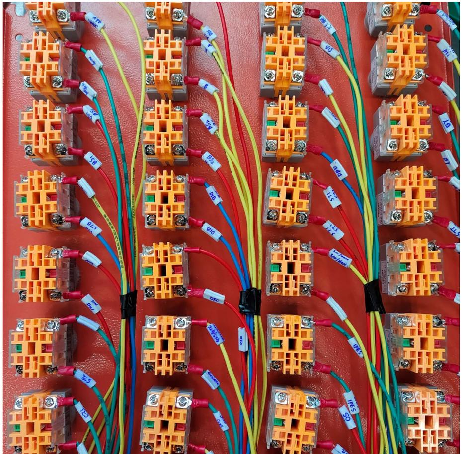
故障箱内控制面板反面接线图
